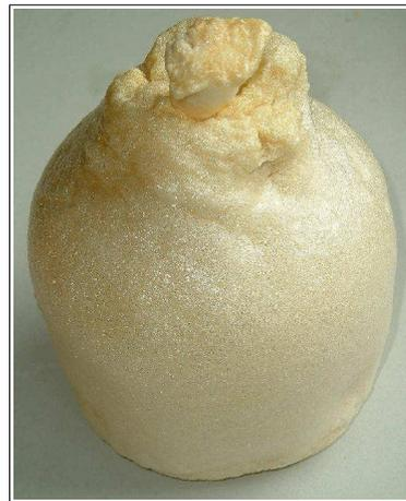
Mit einem Holz- oder Glasstab wird gerührt, bis eine Reaktion einsetzt. Das Volumen des sich bildenden Schaumstoffs ist bis zu 30mal so größer, als das der Edukte.
