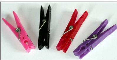
Die namensgebende Besonderheit der Thermoplaste ist, dass sie bei Hitze verformt werden können. Da die Polymerketten allerdings nicht alle identisch sind, hat man unterschiedliche Atomgewichte und somit verschiedene Wechselwirkungen der Atome untereinander (im Grunde liegt ein Gemisch vor!). Als Konsequenz haben die Polymerketten unterschiedliche Schmelz- und Siedepunkte, sodass der ganze Kunststoff eher Schmelz- und Siedebereiche, anstelle von exakten
