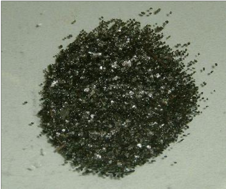
Graphit (leichter Glanz und plattenförmiger Aufbau)
